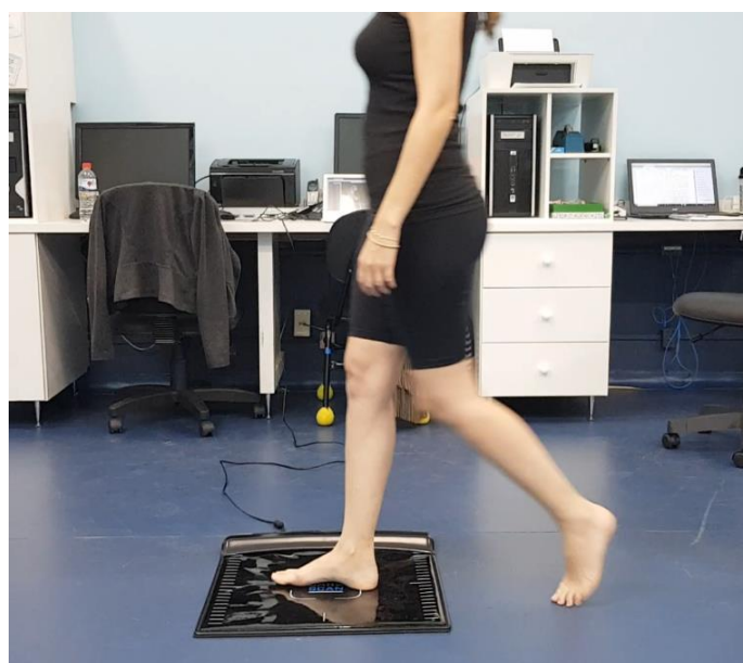
Figura 4 Marcha sobre a plataforma de pressão (BaroScan®).
