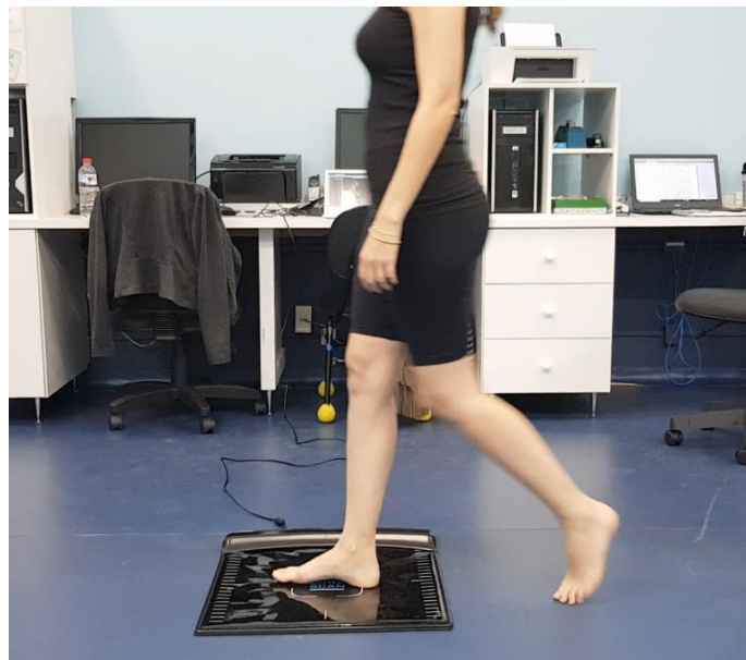
Figura 4 Marcha sobre a plataforma de pressão (BaroScan®).
